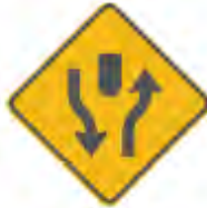
SP-62 INICIO VÍA CON SEPARADOR
