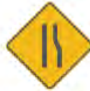
SP-39 REDUCCIÓN ASIMÉTRICA DE LA CALZADA DERECHA
