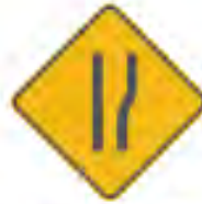
SP-43 ENSANCHE ASIMÉTRICO DE LA CALZADA DERECHA
