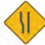
SP-42 ENSANCHE ASIMÉTRICO DE LA CALZADA IZQUIERDA
