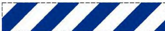
Figura 11 - Marcado de la señalización de seguridad para indicar instrucción Obligatoria
