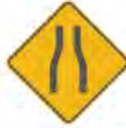
SP-38 REDUCCIÓN SIMÉTRICA DE LA CALZADA
