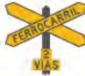
SP-33 PASO FERROVIARIO A NIVEL (CRUZ DE SAN ANDRÉS)
