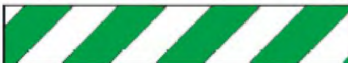
Figura 12 - Marcado de la señalización de seguridad para indicar condición segura
