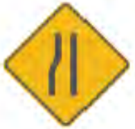
SP-40 REDUCCIÓN ASIMÉTRICA DE LA CALZADA IZQUIERDA
