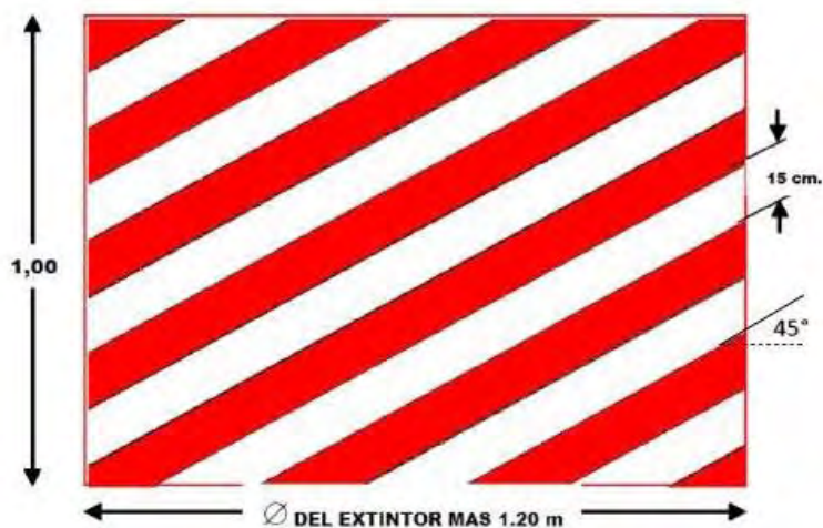
Figura 7b - Señalización horizontal o en el suelo debajo del extintor
